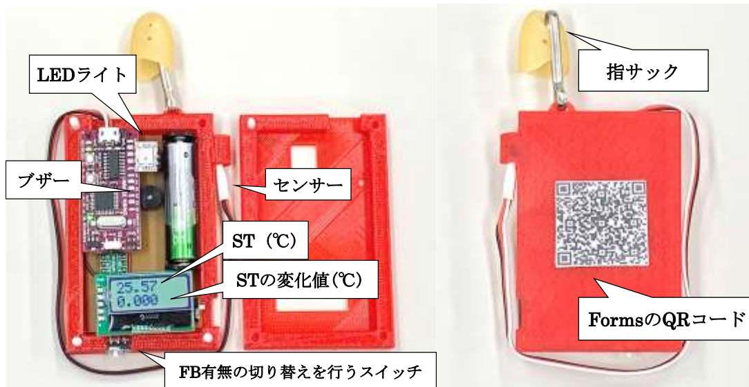
図 1-1 自作ストラップ型 BF 装置の外観と各種機能
