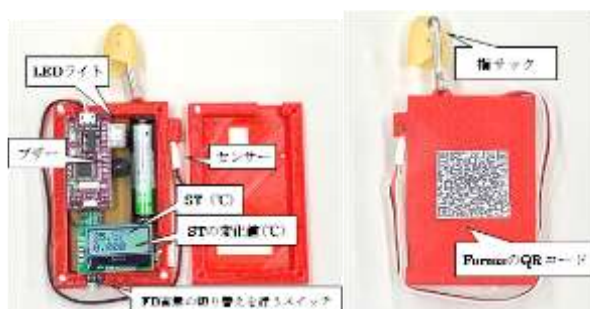
図1 自作ストラップ型BF装置の外観と各種機能
